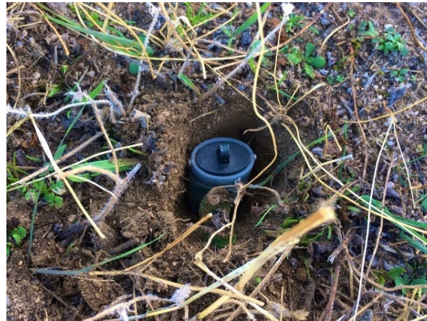
Figura 2. Medidor continuo de temperatura HOBO ubicado en el agujero en el suelo en el que permanecerá durante el periodo de duración del proyecto. La fotografía está tomada antes de completar el enterramiento del dispositivo, cuya parte superior quedará a 2 cm de la superficie del suelo.
