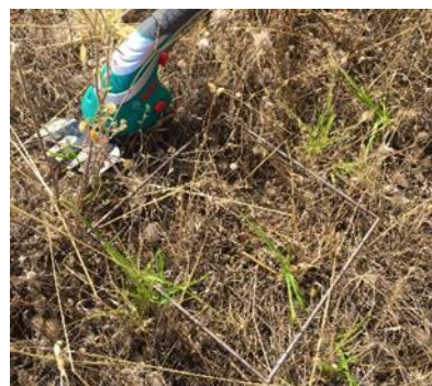
Figura 2. Segadora manual y cuadrado de muestreo de 20 cm x 20 cm utilizado para la recolección de biomasa (izqda.), y recogida de esta en parcela erosionada.
